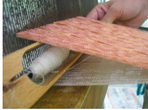
Resim 2. 5:Alt Ağızlık ve alt atkı
