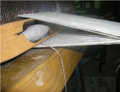
Resim 3. 3: Gri çözgü ağızlığı ve atkısı
