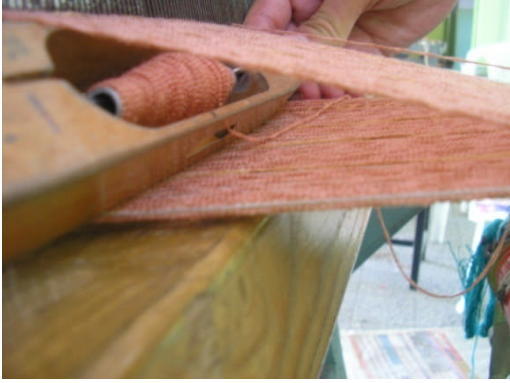
Resim 2. 4:Üst ağızlık ve atkı
