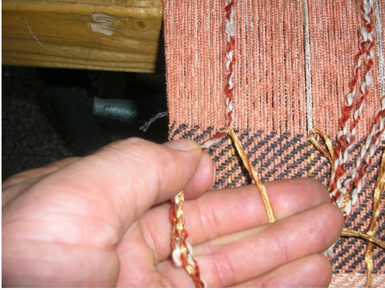
Resim 2. 7: Varyant için iplik eklemek
